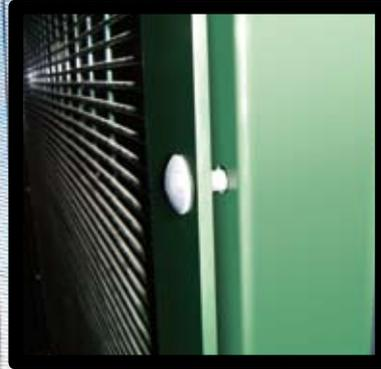
Clôture de haute sécurité, maille anti-escalade rendant le franchissement pratiquement impossible. S'adapte sur poteaux en tube de section dimensionnée en fonction de la hauteur de la clôture. Fixation des panneaux par plats de jonction, inserts et vis inviolables. Les pentes sont réalisées par échelonnement.
